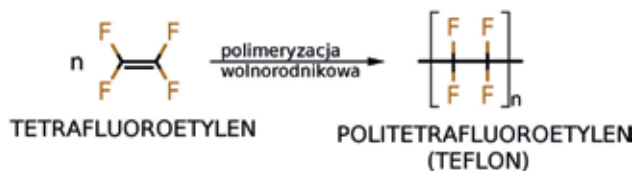
Ryc. 4. Schemat produkcji teflonu.
